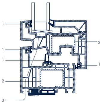
\*Le joint extérieur arrête le vent, l'eau et la poussière. Le joint central protège les ferrures. La combinaison de tous ces joints assure une isolation acoustique supplémentaire de -3 dB.
